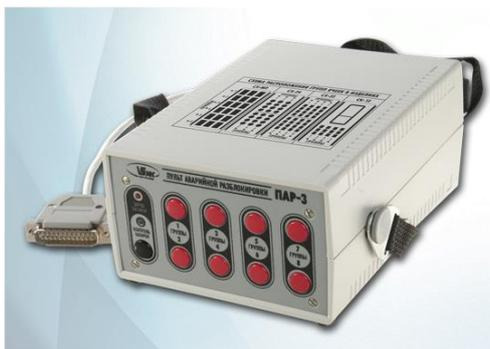
Принцип действия пульта состоит в подаче напряжения от встроенного аккумулятора на выбранную группу ячеек сейфа для их разблокировки. В составе пульта имеется зарядное устройство. Предусмотрена также возможность работы пульта от внешнего источника 12 Вольт.
