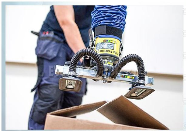
Многофункциональный подъемник High-frequency lifter (VacuEasylift) TAWI может работать с широким выбором присосок для различных целей и груза любой формы, массы и габаритов.
