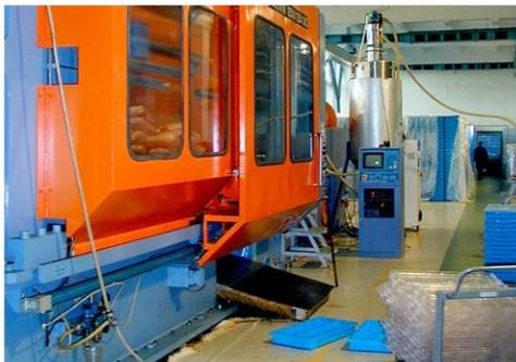
**ООО "ЭВС" обладает технологическими и производственными возможностями** изготовления крупногабаритной промышленной тары, как на оснастке заказчика, так и на оснастке собственной разработки и изготовления. Для производства тары имеются литьевые машины с усилием смыкания от 120 т до 1250 т с объемом впрыска до 4 кг.
