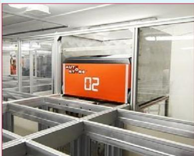
Лифт для загрузки/выгрузки роботов на стеллаж.
